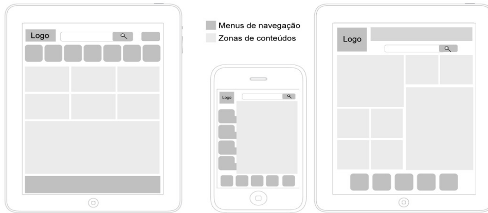
Figura 01: Arquiteturas de wireframes , respectivamente, para sites web mobile e de apps de smartphones e tablets .
